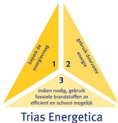
Figuur 1. Principes Trias Energetica, internationaal geïntroduceerd door Lysen E. (1996) Nederlandse Onderneming voor Energie en Milieu
